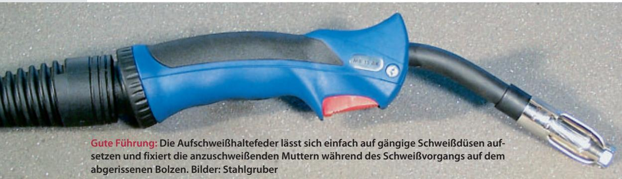
**Gute Führung:** Die Aufschweißhalterfeder lässt sich einfach auf gängige Schweißdüsen aufsetzen und fixiert die anzuschweißenden Muttern während des Schweißvorgangs auf dem abgerissenen Bolzen. Bilder: Stahlgruber
